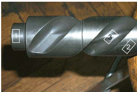
Figure 6. Sample positions on idle rotor. Slika 6. Uzorci sa slobodnog vretena
