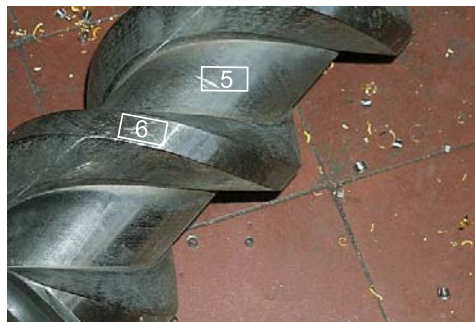
Figure 7. Sample positions on main screw (sample 4 is on rotor end). Slika 7. Uzorci sa pogonskog vretena (uzorak 4 je na kraju vretena)
