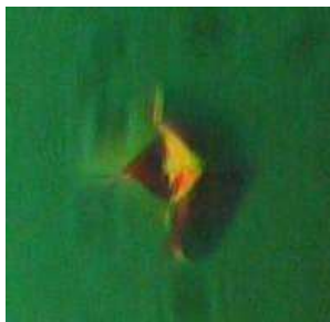
Slika 1 - Fotografija utiska na podlozi Si pri opterećenju od 40 p snimljena na metalografskom mikroskopu. Dijagonala utiskivača je paralelna \langle 110 \rangle pravcu u (100) ravni monokristalnog Si.
