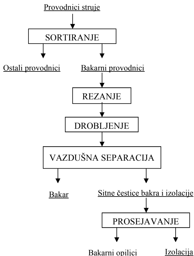
Slika 2 - Tehnološki postupak pripreme provodnika struje
