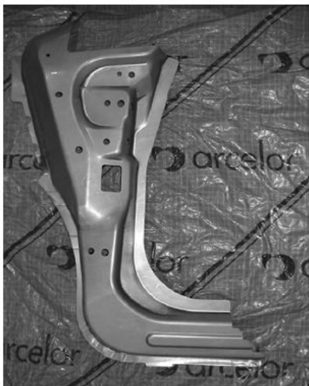
Slika 9. Auto delovi napravljeni od TWIP čelika dobijeni jednom operacijom presovanja [2,4].
