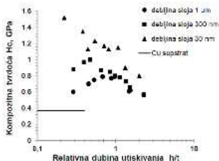
Slika 2 - Varijacija kompozitne tvrdo e H_c , sa relativnom dubinom utiskivanja, h/t , za Ni/Cu filmove debljine 5 \mu\text{m} na Cu supstratu. Debelom linijom ozna ena je apsolutna vrednost tvrdo e Cu supstrata H_S = 0.37 \text{ Pa}
