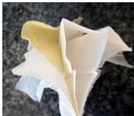
Slika 1. Prikaz ugrađenih filtrirajućih materijala u filtrirajućoj polumaski
