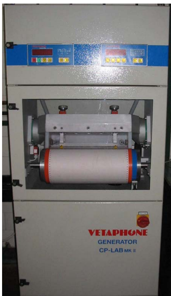
Slika 26. Uređaj za obradu tekstilnih materijala korona pražnjenjem
