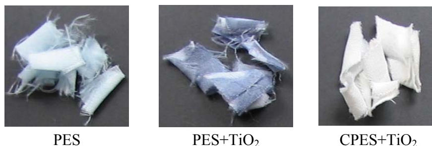
Slika 43. Izgled PES uzoraka obrađenih nanočesticama TiO 2 nakon 4 ciklusa osvetljavanja
