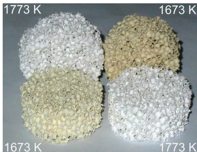
Slika 21. Sinterovane pene na bazi \alpha -Al 2 O 3
