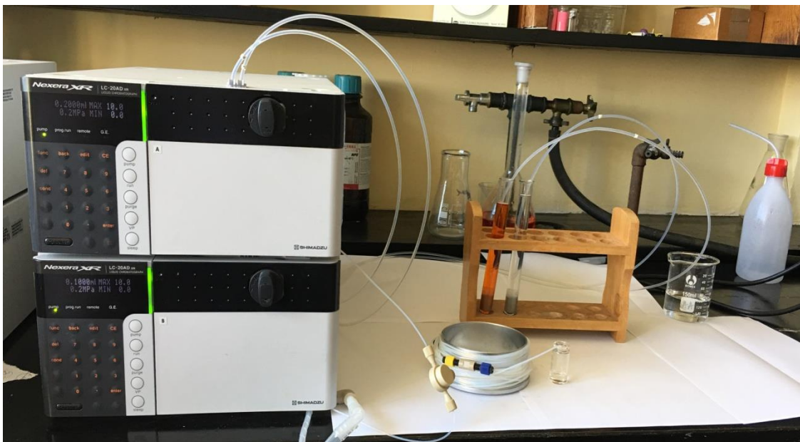
Slika 12. Postavka eksperimenta, T mikser povezan sa PEEK kapilarama
