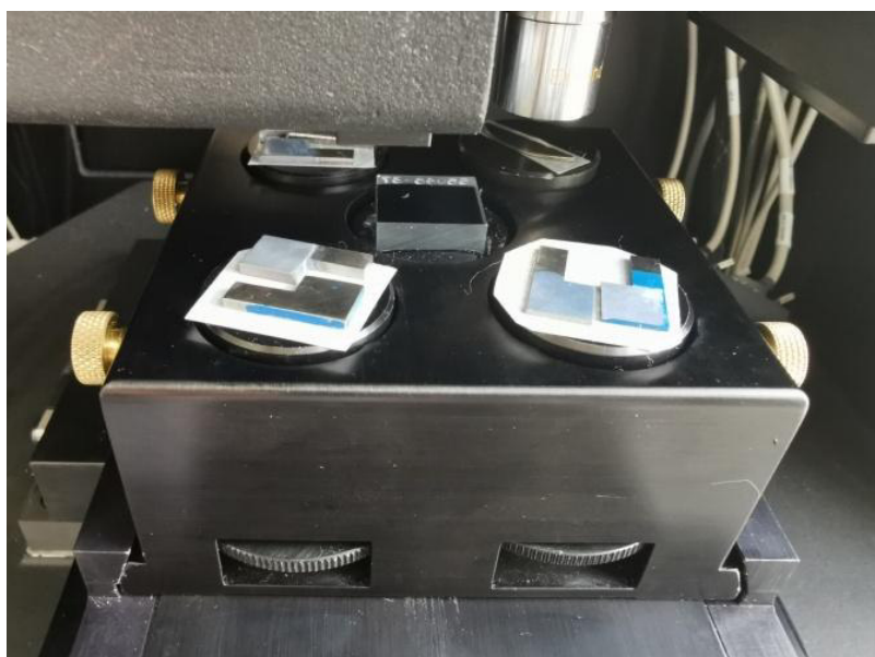
Slika 7.12 Uzorci pripremljeni za ispitivanje nanoindentacijom
