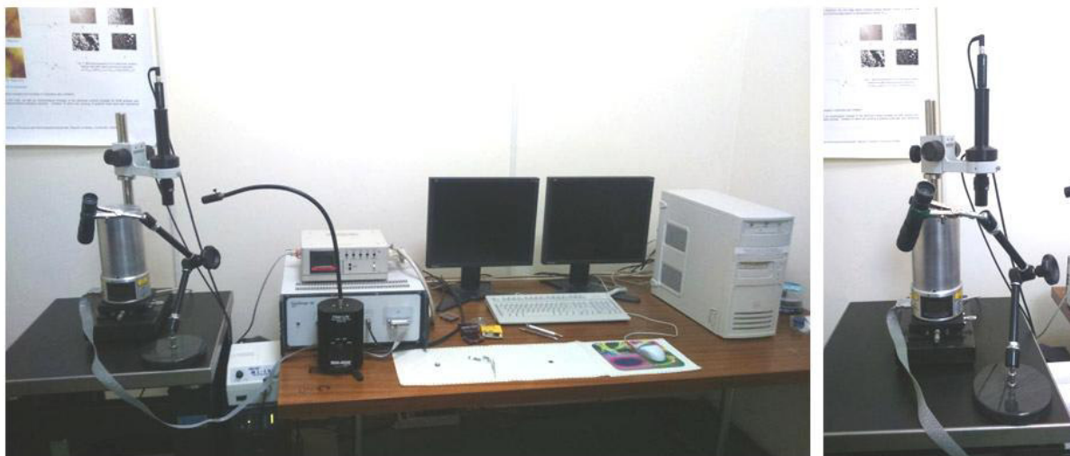
Slika 7.7 Mikroskop atomskih sila - Veeco - Nanoscope III d
