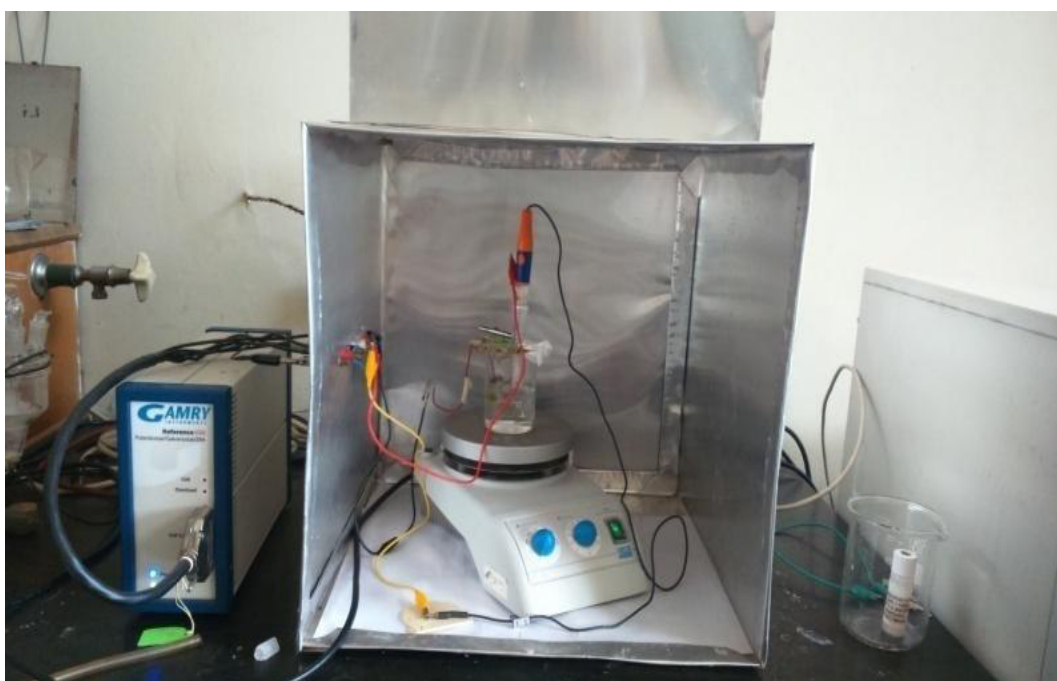
Slika 7.8 Aparatura korišćena za elektrohemijska ispitivanja
