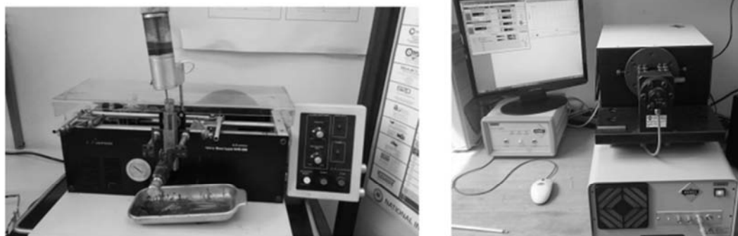
Figure 5. a) Device for creating an initial fatigue pre-crack b) Fatigue device Crafronic Rumuli Slika 5. a) Uređaj za stvaranje inicijalne zamorne predprsline b) Uređaj za izazivanje zamora Crafronic Rumuli
