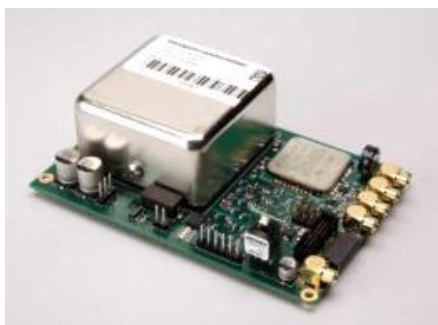
Sl. 8. GPSDO modul, bez prijemnika, proizvođača Acquisys [14].
