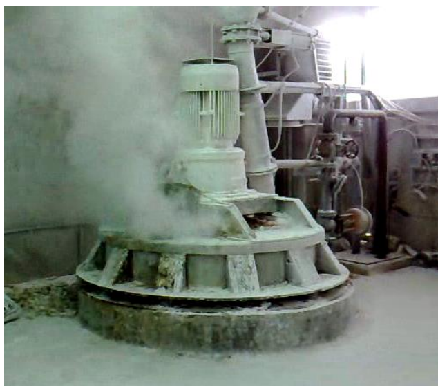
Slika 13. Šaržni reaktor (kuvac) za pripremu skroba
