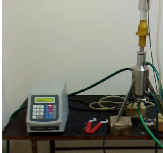
Slika 2. Ultrazvučni procesor i sonda sa protočnom ćelijom
