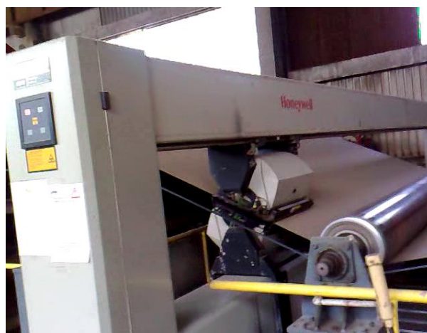
Slika 15. Skener papira u Fabrici Hartije Beograd
