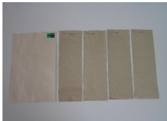
Slika 5. Uzorci papira nakon nanošenja disperzija sa različitim procentom sepiolita
