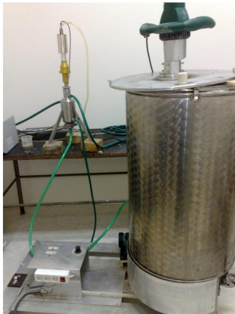
Slika 3. Rezervoar sa disperzijom sepiolita povezan sa ultrazvučnom protočnom ćelijom
