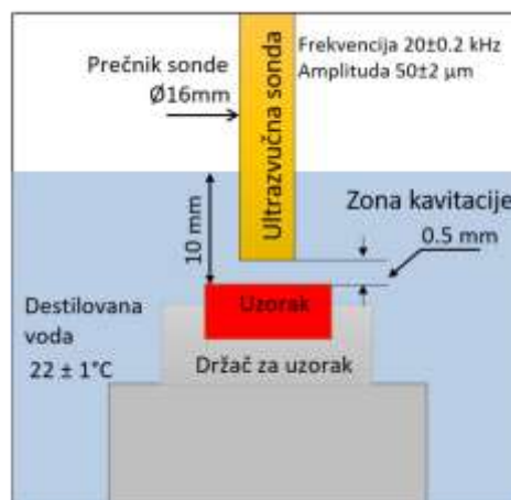
Slika 1 - Šematski prikaz uređaja za ispitivanje dejstva kavitacije.
