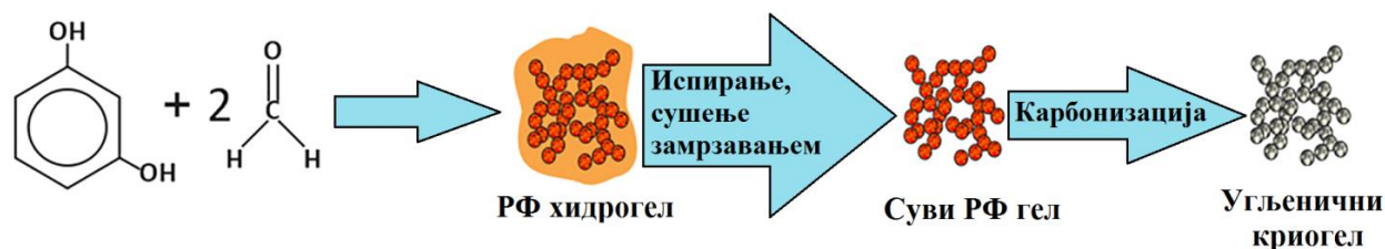
Слика 9. Синтеза РФ угљеничног криогела [106]
