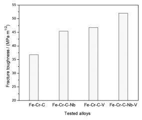
Figure 9: Dynamic fracture toughness of the tested alloys Slika 9: Dinamična lomna žilavost preizkusnih zlitin
