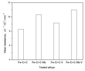
**Figure 8:** Wear resistance of the tested alloys **Slika 8:** Obrabna odpornost preizkusnih zlitin
