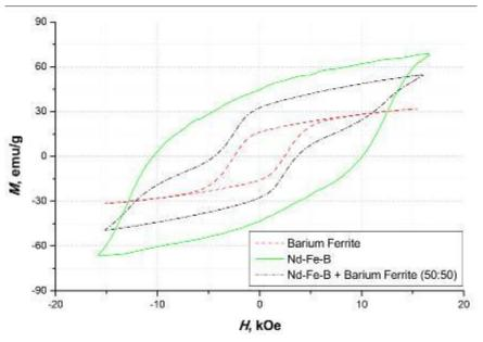
Figure 6. Hysteresis loops of magnetic composite materials Slika 6. Histerezisna petlja magnetnih kompozitnih materijala
