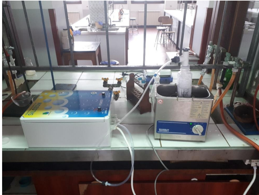
Slika 3. Aparatura korišćena za eksperimentalni rad (ozonizator - GENERATION SILVEROZON SILOZON i ultrazvučno kupatilo - BANDELIN SONOREX)
