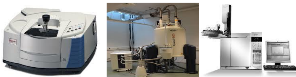
Slika 1. Uređaji korišćeni za strukturu i morfološku analizu uzoraka vode (ATR-FTIR, NMR i GC)
