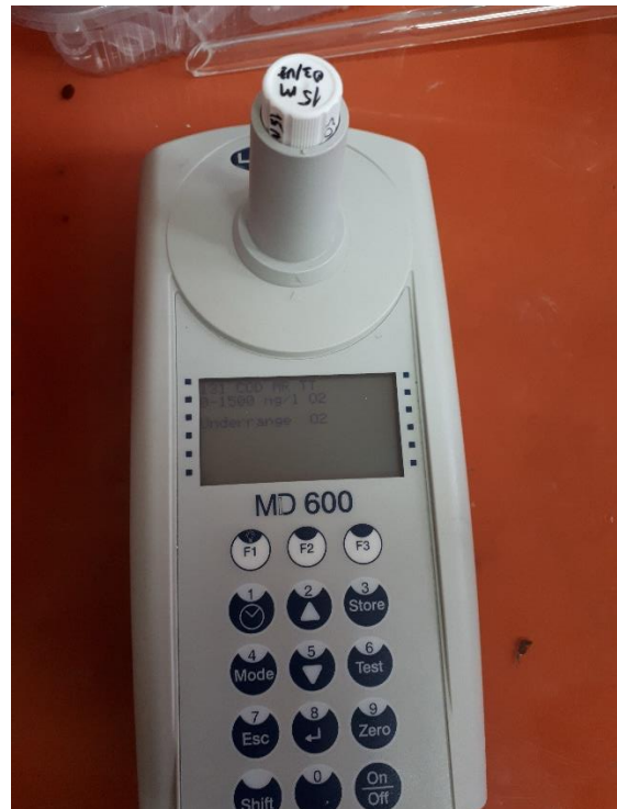
Slika 4. Aparatura za pripremu uzorka i spektrofotometar korišćeni za određivanje HPK vrednosti uzoraka tretirane otpadne vode
