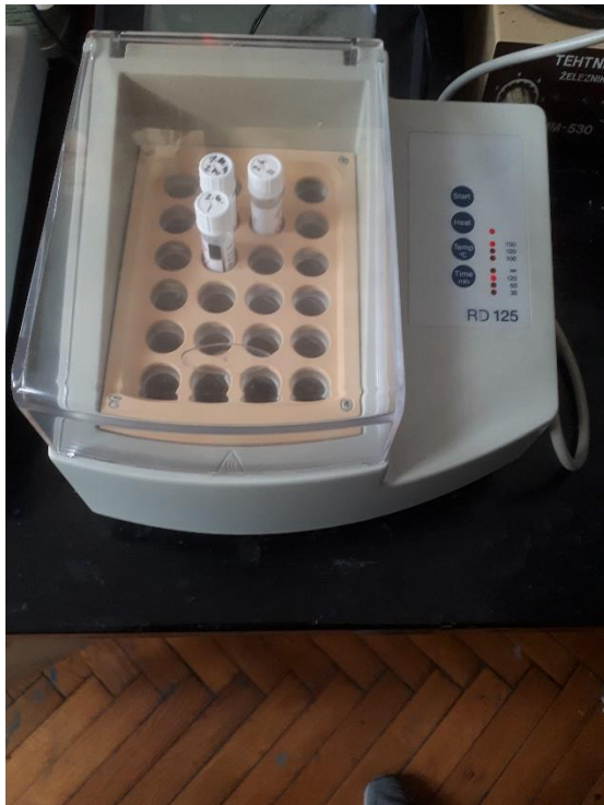
Slika 4. Aparatura za pripremu uzorka i spektrofotometar korišćeni za određivanje HPK vrednosti uzoraka tretirane otpadne vode
