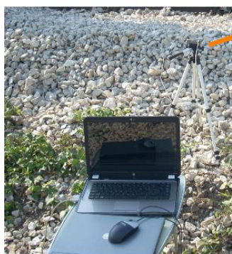
Slika 8.3 Laserski sistem za merenje statičkog ugiba šina
