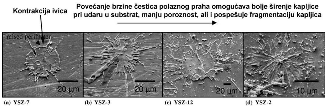
Sl.20. Uticaj brzine čestica polaznog YSZ praha na morfološka svojstva depozita nakon udara potpuno istopljene čestice ovog praha (adaptirano iz [14]).
