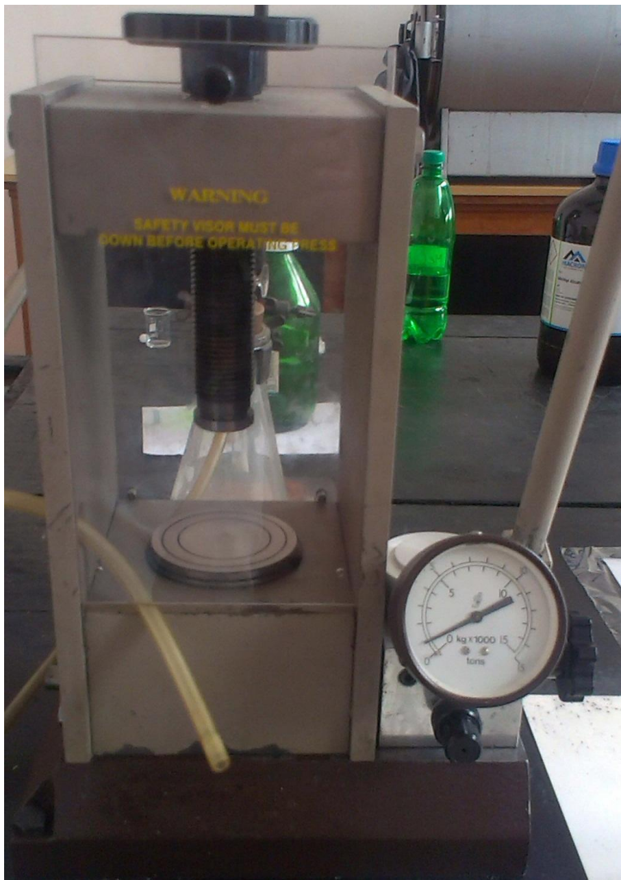
Sl.A6-3-3. Hidraulična presa (15 t) za pravljenje tableta u hladno presovanom stanju od praškastih materijala se nalazi na Katedri za organsku hemiju, Tehnološko-metalurški fakultet, Univerzitet u Beogradu, Srbija.
