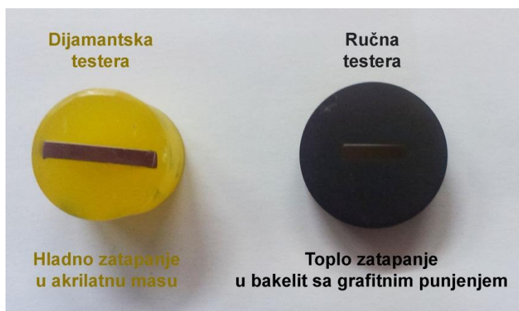
Sl.91. Makro-fotografije prikazuju tipičan izgled poliranih poprečnih preseka hladno (levo) i toplo (desno) zatopljenih uzoraka HA prevlaka.
