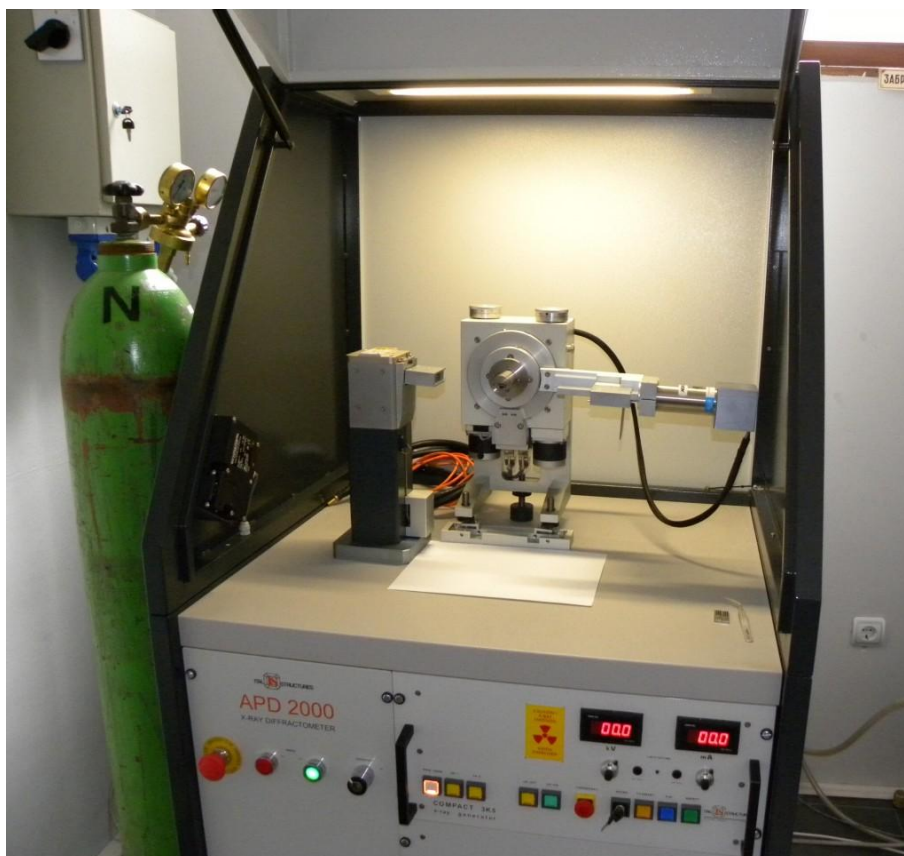
Sl.A6-2-2. Difraktometar Ital Structure APD 2000 se nalazi na Katedri za opštu i neorgansku hemiju Tehnološko-metalurškog fakulteta, Univerzitet u Beogradu, Srbija.
