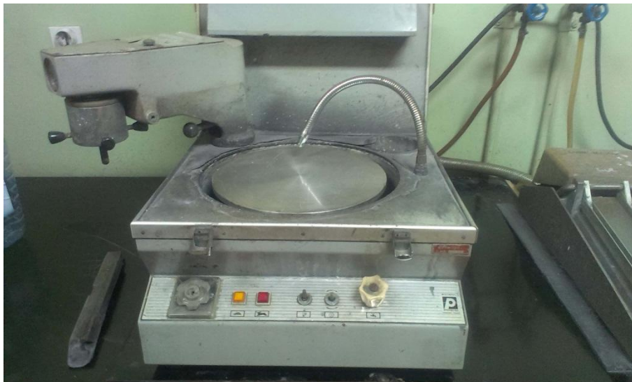
Sl.A6-7-1. Uređaj na kome je izvršeno brušenje poprečnih preseka HA prevlaka se nalazi na Katedri za metalurško inženjerstvo, Tehnološko-metalurški fakultet, Univerzitet u Beogradu, Srbija.
