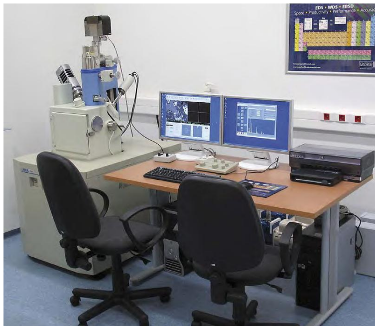
Sl.A6-9-1. JEOL JSM-6610 LV SEM sa instaliranim Oxford Instruments X-Max SDD EDS se nalazi na Departmanu za mineralogiju, Rudarsko-geološki fakultet, Univerzitet u Beogradu (adaptirano iz [247]).
