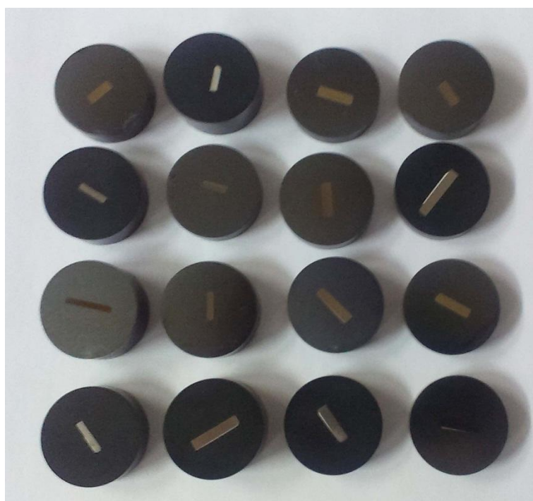
Sl.A6-7-4. Makro-fotografije prikazuju tipičan izgled poliranih poprečnih preseka jedne serije ispitivanih toplo zatopljenih uzoraka HAP-fp i HAP-kp nanesenih pri različitim SOD i Ts koji su sečeni ručnom testerom.
