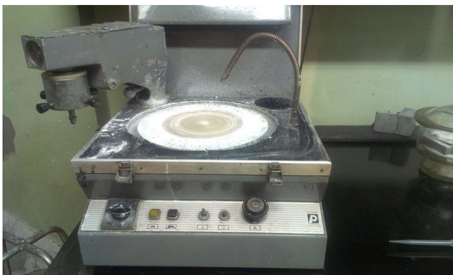
Sl.A6-7-2. Uređaj na kome je izvršeno poliranje poprečnih preseka HA prevlaka se nalazi na Katedri za metalurško inženjerstvo, Tehnološko-metalurški fakultet, Univerzitet u Beogradu, Srbija.
