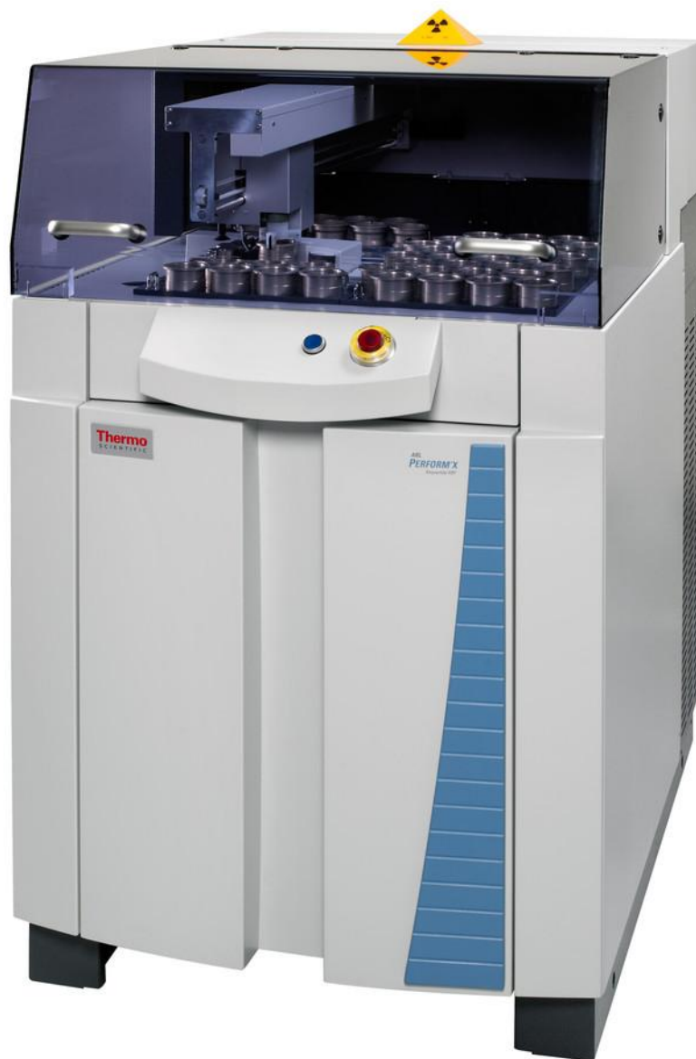
Sl.A6-1-1. Model ARL PERFORM'X za energetska-disperzivnu fluorescenciju rentgenskih zraka proizvođača (Thermo Fisher Scientific) kakav poseduje Hemijski fakultetu, Univerzitet u Beogradu, Srbija.
