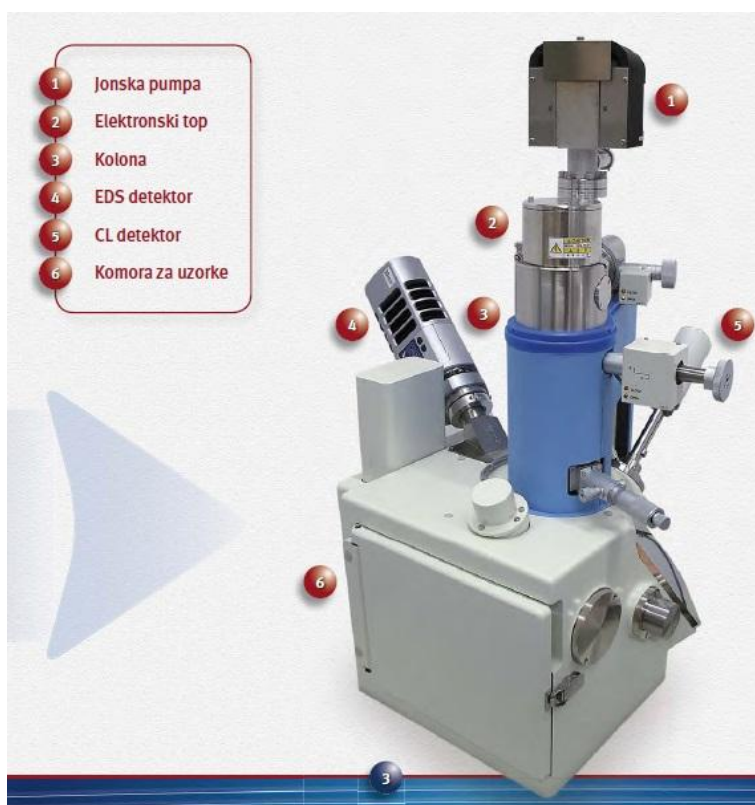
SLA6-9-4. Osnovni i dodatni delovi oko kolone JEOL JSM-6610 LV SEM (adaptirano iz [247]).
