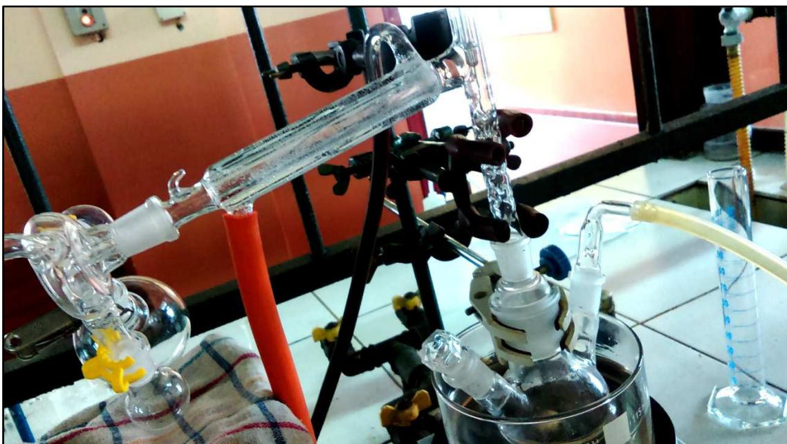
Slika 14.1 Prečišćavanje monomera MMA destilacijom u cilju uklanjanja inhibitora i PMMA polimera
