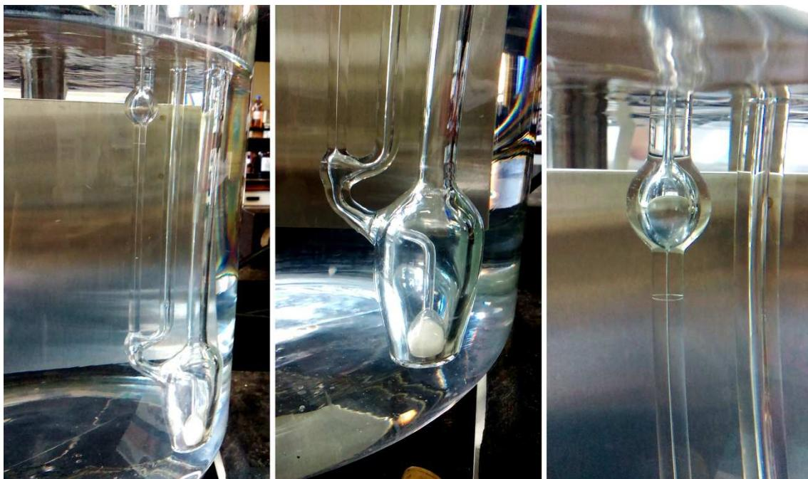
Slika 19.7 Viskozimetar po Ubelodeu korišćen za merenje viskoznosti polimernih adheziva i polimernih blendi
