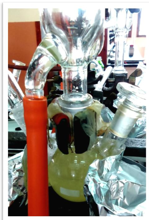
Slika 14.3 Hidroliza EVA kopolimera u suvim uslovima u inertnoj atmosferi azota sa rastvorom NaOH/EtOH u refluksu uz mešanje
