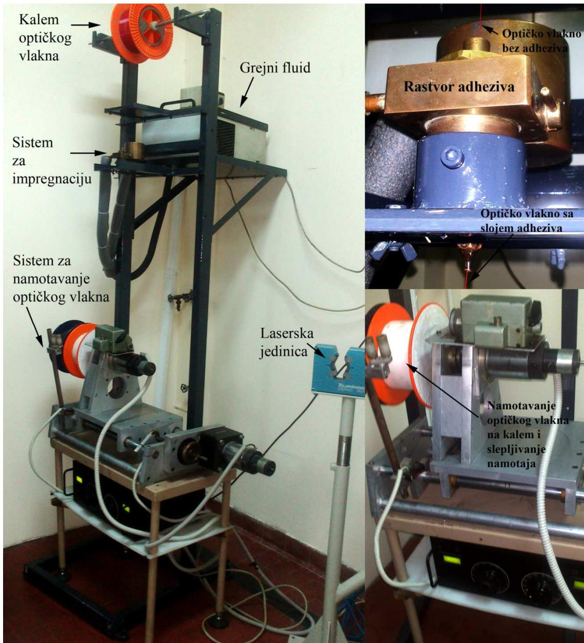
Slika 15.2 Aparatura korišćenja u procesu nanošenja adheziva na optičko vlakno
