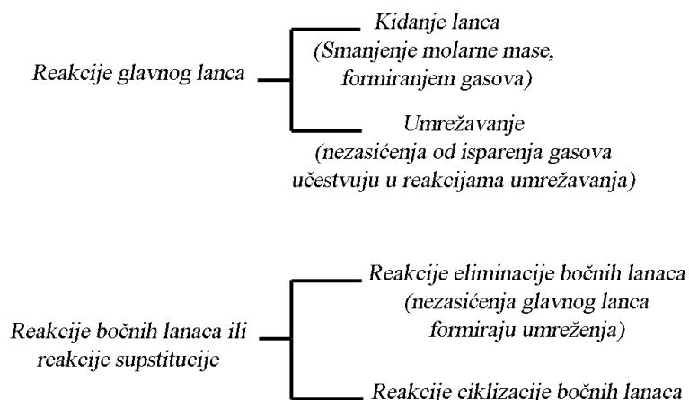
Slika 5.2 Opšti mehanizmi degradacije polimera
