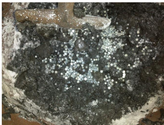
Slika 41. Komponente solidifikata sa markerima za određivanje vremena homogenizacije
