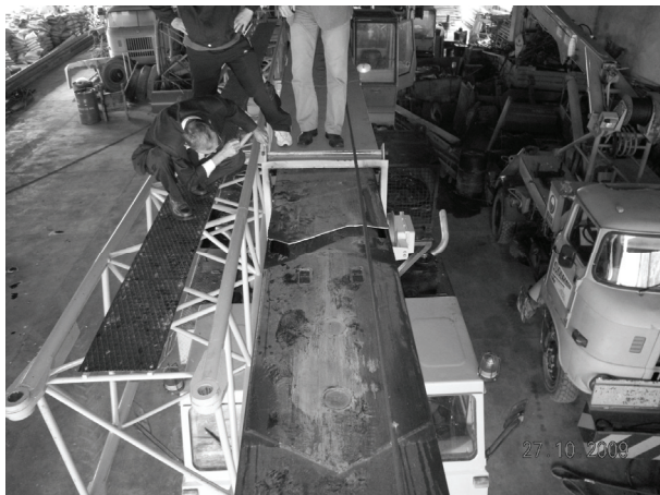
Slika 2: Priprema segmenata autodizalice za sanaciju
