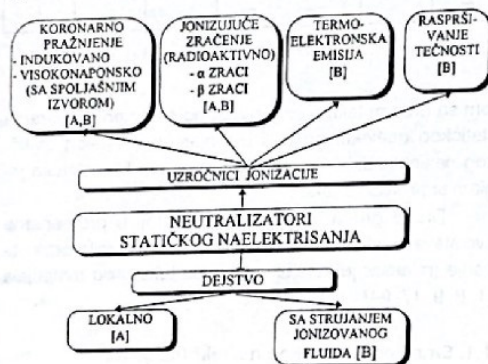
Slika 2. Neutralizatori statičkog naelektrisanja A - lokalni; B - sa usmerenim strujanjem jonizovanog fluida Figure 2. Neutralizers of static electricity: A - local; B - with directed flow of an ionized fluid
