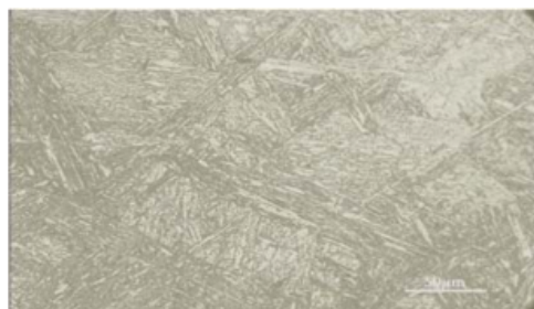
Slika 1. Mikrostruktura martenzitnog nerđajućeg čelika.
