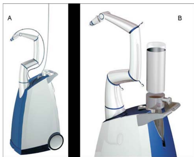
Figure 3 Operating device (A); detailed cassette with abrasive (B) [6] Slika 3. Operacijski uređaj (A); detalj kasete s abrazivom (B) [6]
