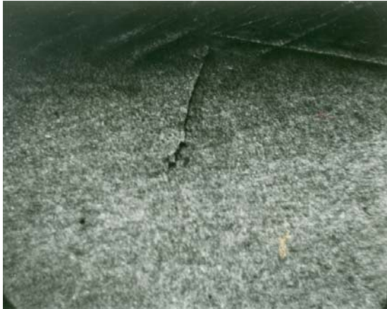
Figure 5. Carburized zone with the crack, hardness values between 600 and 700 HV. Slika 5. Cementirana zona sa prslinom, vrednosti tvrdoće između 600 i 700 HV
