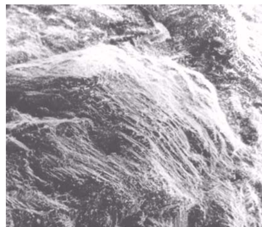
Figure 9. Fatigue striations on fractured surface, \times 5000 . Slika 9. Linije zamaranja na prelomnoj površini, \times 5000
