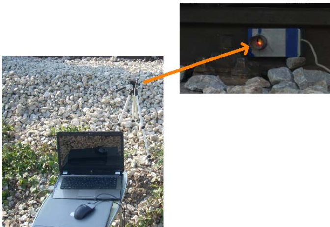
Slika 8. Laserski sistem za merenje statičkog ugiba šina
