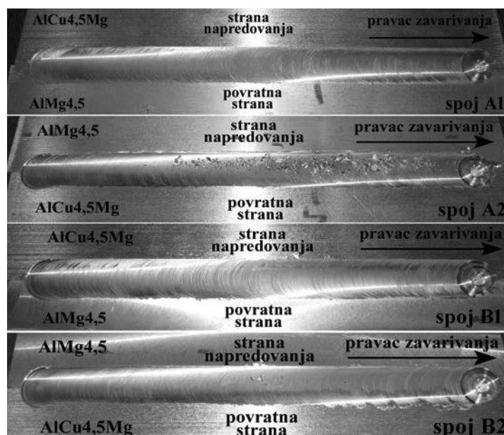
Slika 5. Zavareni spojevi – izgled lica spoja
