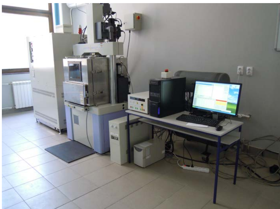
Slika 54. Uređaj za ispitivanje udarom kontrolisane energije
