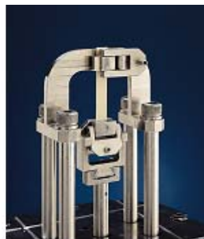
Slika 35. Šematski prikaz i fotografija test aranžmana zatezanja (DMA Q800) [113]
