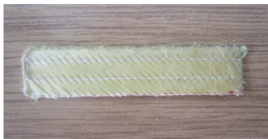
Slika 53. Uzorak Kolon lamine impregnisane PVB rastvorom za ispitivanje DMA
