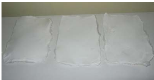
Slika 49. p -aramidne lamine deponovane PVB-SiO 2 vlaknima
