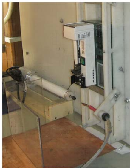
Slika 52. Uređaj za elektropredenje na Tehnološko-metalurškom fakultetu u Beogradu
