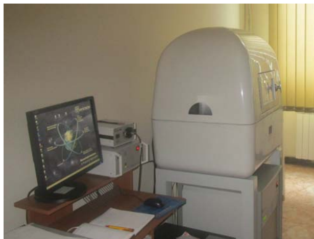
Slika 56. Uređaj za nanoindentaciju na Tehnološko-metalurškom fakultetu u Beogradu
