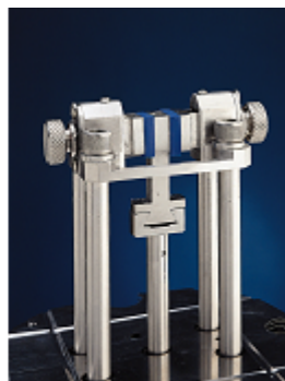
Slika 37. Šematski prikaz i fotografija „sendvič” aranžmana (DMA Q800) [113]
