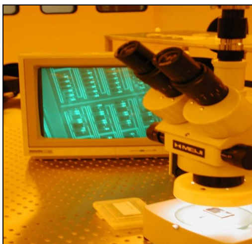
Slika 4.2. Optički mikroskop i prikaz čipa sa 384 polimerne mikrokonzole (Micro and Nano Technology Centre u Rutherford Appleton Lab., Science and Technology Facilities Centre (STFC), Južni Oksfordšir)
