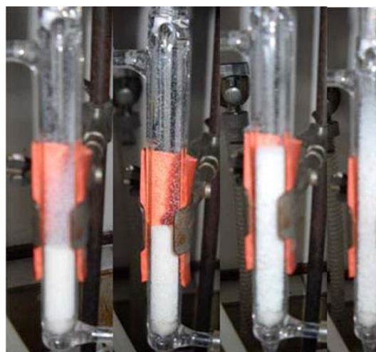
Slika 4.31. Uticaj zapreminskog protoka na zapreminu fluidizovanog sloja.
