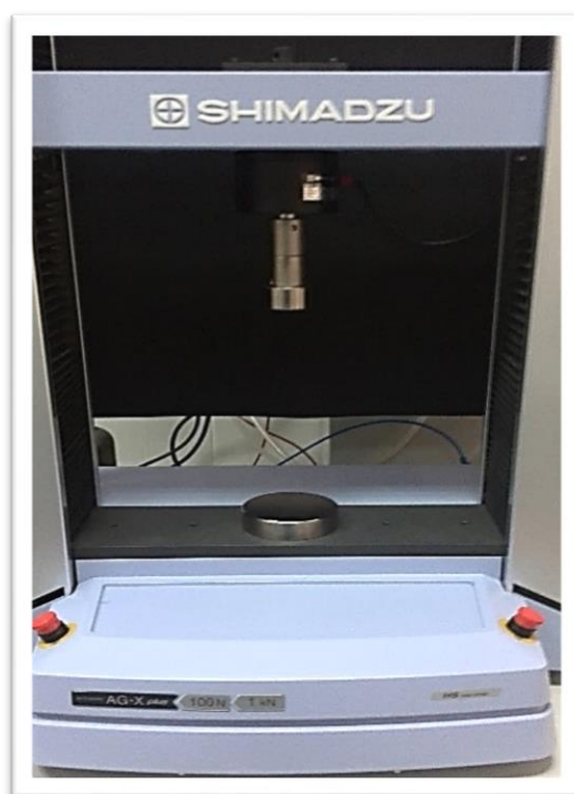
Slika 4.5. Oprema za ispitivanje mehaničkih svojstava hidrogel sistema, AG-Xplus Universal Testing Machine (Shimadzu, Japan).
