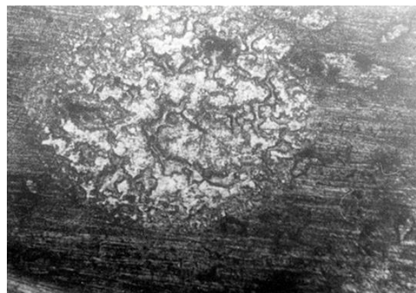
Slika 7. Čelik sa bakarnom prevlakom, Top Hat Nd 3+ :YAG lasera, sa parametrima: \tau = 2 \times 2 ms, spot size = 2 mm, \lambda = 1064 nm, krater E=9,06 J.
