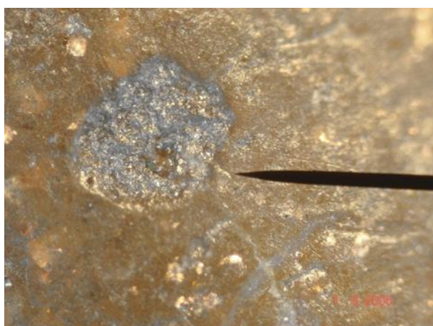
Slika 6. Smeđi vosak, Nd 3+ :YAG laser, impuls širine 15 ns i energije 35 mJ, krater P1, 1imp., OM 40x.
