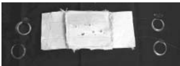
Slika 2. Fotografija kompozitne ploče sa ugrađenim optičkim vlaknima nakon pet balističkih testiranja
